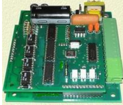
Resim 2.1:Step motor sürücüsü
