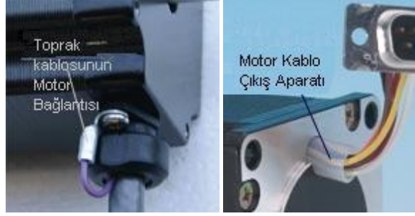
Resim 1.2: Step motor kablo bağlantıları
