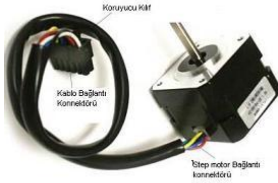
Resim 1.3: Step motor kablo bağlantıları
