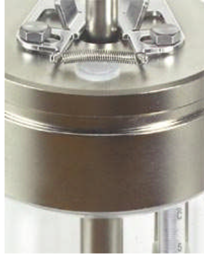
Fotoğraf 1.10: Nansen şişesinin kapanma mekanizması
