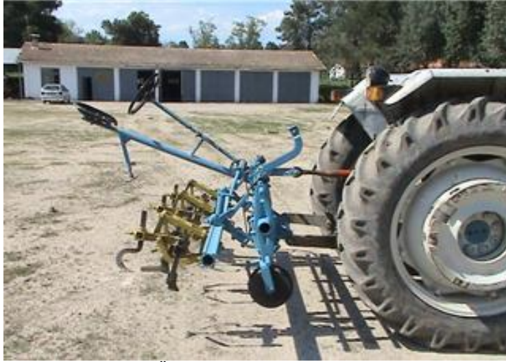
Resim 1.2: Ön arka paralellik ayarının kontrolü
