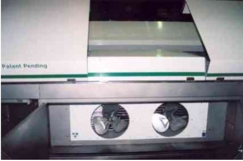
Resim 2.3: Soğutma hattı üzerinde bulunan küçük vantilatörler
