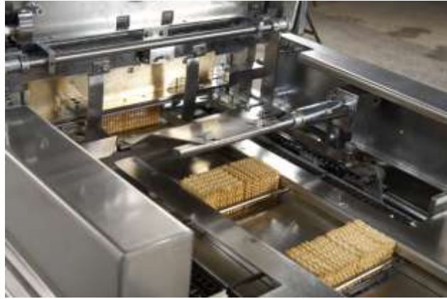
Resim 3.7: Zarf tipi makinede paketlenmek için dizilmiş bisküviler ve paketlenmiş bisküvi
