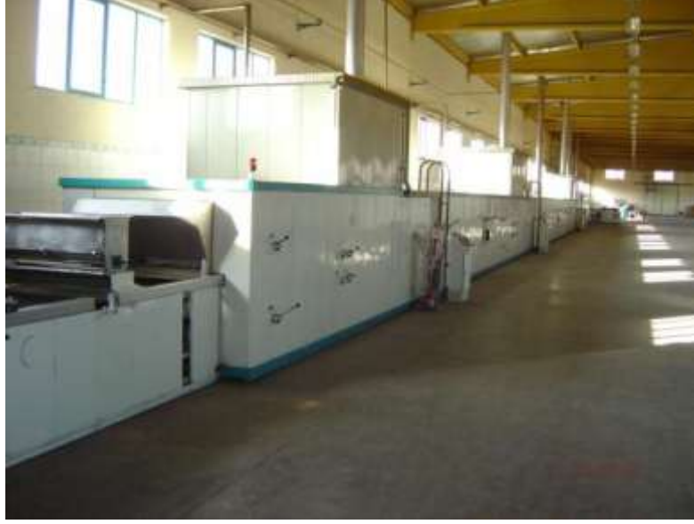
Resim 1.5: Yakıt olarak LPG kullanılan bisküvi pişirme fırını
