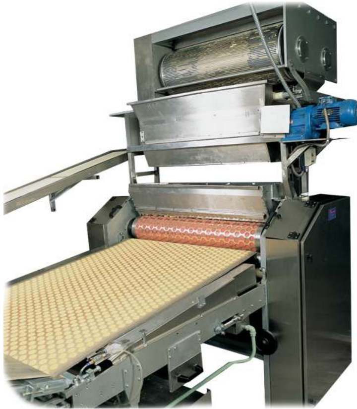
Resim 2.6: Üç ayrı silindir grubuyla çalışmakta olup tıkcı,kauçuk ve kalıp topunun devirleri ayarlanabilir rotatif şekil verme makinesi
