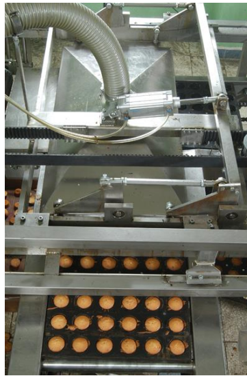
Resim 4.6: Vakumlu kek alma makinesi
