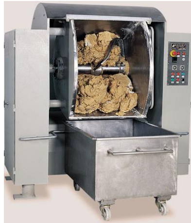
Resim 3.9: Yoğurma işlemi tamamlanmış hamur
