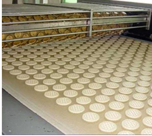
Resim 3.11: Şekillendirilen bisküvi krakerler
