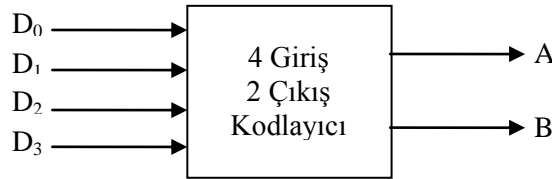
Şekil 1.1: 4 giriş 2 çıkış kodlayıcı devresi blok şeması
