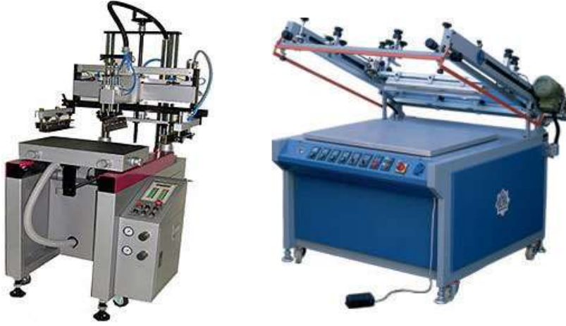
Resim 2.3: Üniversal, tek renkli, yarı otomatik baskı makineleri
