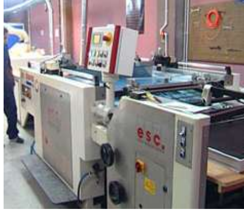
Resim 2.1: Tam otomatik tek renkli baskı makinesi
