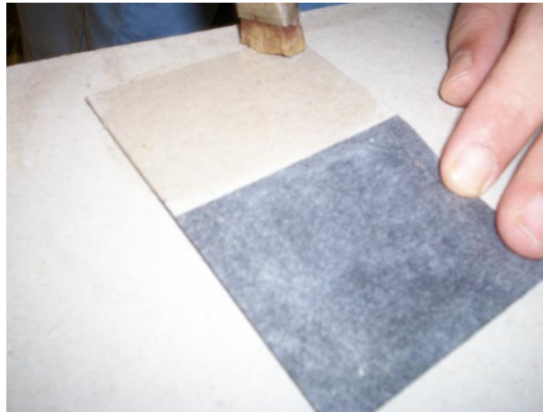
Resim 2.6: Sertleştirme mukavvasına yapıştırıcı sürme
