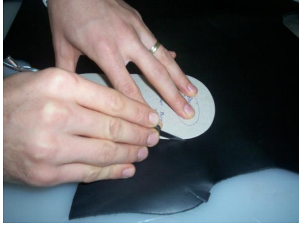
Resim 2.3: Kesim mukavvası ile kesim yapma
