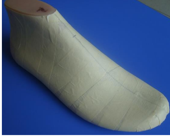
Resim 1. 7: Kalıbın üst yüzeyinin bantlanması
