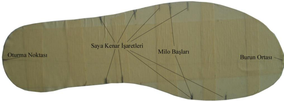
Resim 4. 1: Kalıp alt formunun kartona yapıştırılmış hâli
