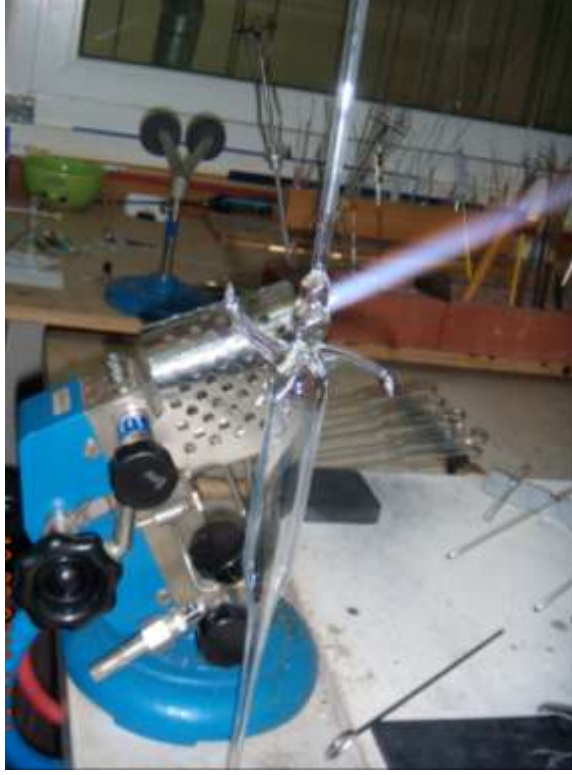
Resim 1.2: Üç sistem ayarları yeni model şalümo
