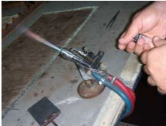
Resim 1.1: Oksijen, gaz ve hava sistemi olan şalümo modeli
