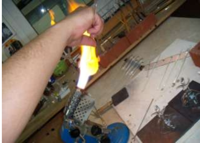
Resim 1.5: Üfleme kullanılan biçimlerde daha yüksek alev kullanımı
