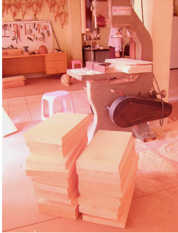
Resim 1.2: Şerit testere makinesinde kapak kesimi
