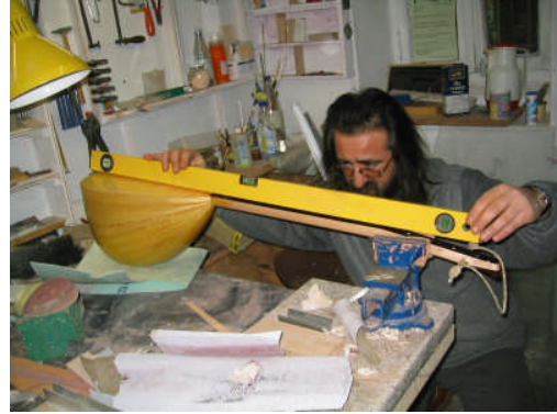
Resim 1.11: Tesviye kontrolünün yapılması
