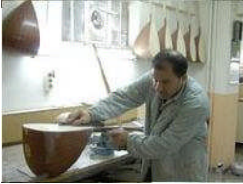
Resim 1.10: Yüzeyin tesviye edilmesi
