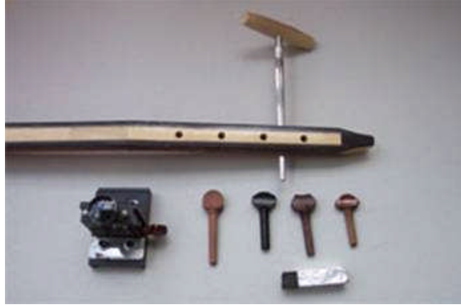
Resim 3.5: Burgular rayba ve burgutıraş ile yerlerine alıştırılır
