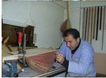
Resim 1.7: Kapak altından markalama
