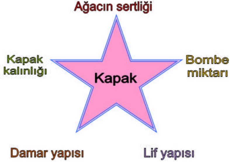
Şekil 1.2: Kapak ağacında ses iletimini etkileyen faktörler
