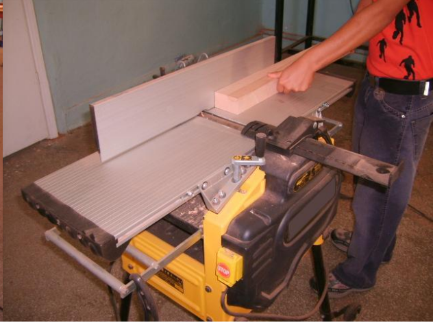
Şekil 2.2 : Şerit testere makinesinde kaba kesim Şekil 2.3 : Planya makinesinde yüz, cumba açmak
