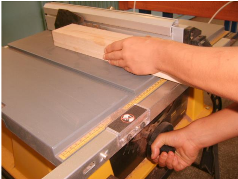
Şekil 2.7 : Testere yükseklik kontrolü yaparken Şekil 2.8 : Dilim kalınlıkları kesilirken
