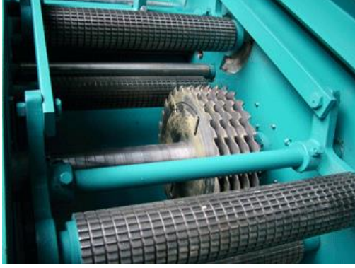
Şekil 2.5 : Daire testere makinesi kesici görünümü Şekil 2.6 : Çoklu dilme makinesi kesici görünümü
