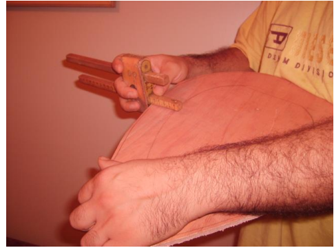
Şekil 1.25: Nişangeç ile paralel eğmeç markalaması
