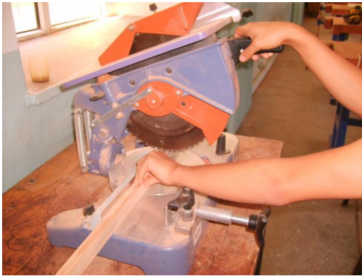
Şekil 2.9: Gönyeburun boy kesme makinesinde dilim boyunun kesimi
