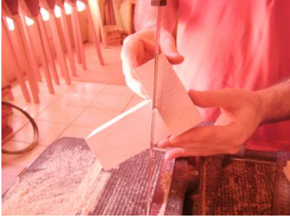
Şekil 1.52 : Ön takozun kaba kesimi
