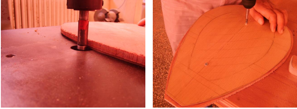
Şekil 1.31: Şablonun alt parçaya montesi Şekil 1.32 : Üst freze makinesinde şablon ile parça temizlemek
