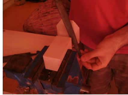
Şekil 1.53: Ön takozu törpü ile form verilirken
