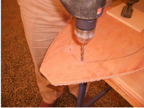
Şekil 1.24: Kalıp alt parçası delinirken
