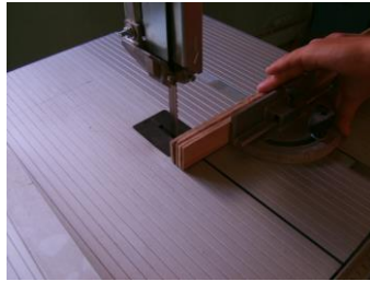
Şekil 2.12: Şerit testere makinesinde dilim boylarının kesimi
