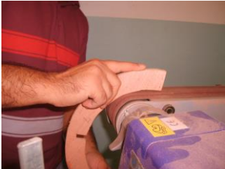
Şekil 1.29: Palet zımparada içbükey zımparalamak
