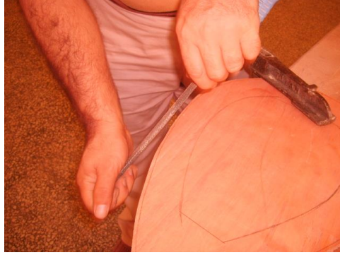
Şekil 1.28: Alt parça eğelenirken
