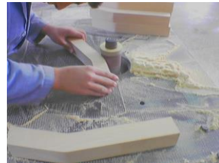
Şekil 1.30: Top zımparada dışbükey zımparalamak
