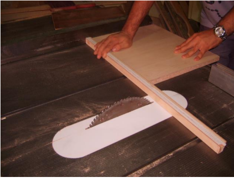
Şekil 2.13: Yardımcı parça ile dilim boyunun kesimi
