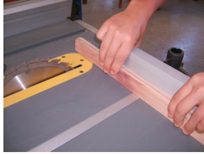
Şekil 2.11: Gönyeburun boy kesme aparatı ile boylama
