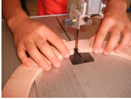
Şekil 1.34: Şerit testere makinesinde yan kayıta kertme açarken
