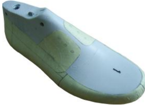
Fotoğraf 3.4: Bağcık kısmının tamamlanması
