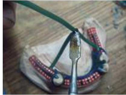
Resim 1.19: Uzun cupa kanalı bırakılmış yanlış kanal bağlama
