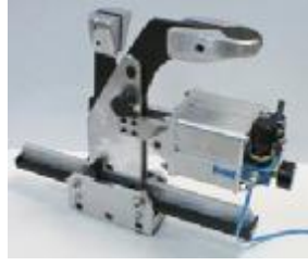
Fotoğraf 8.1: Ayakkabıyı cihaza bağlamakta kullanılan aparat
