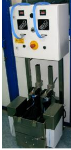
Fotoğraf 7.1: Ayakkabı su geçirmezlik test cihazı
