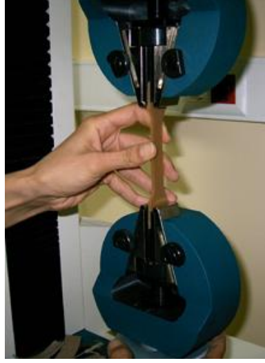
Fotoğraf 2.3: Test parçasının cihaza bağlanması
