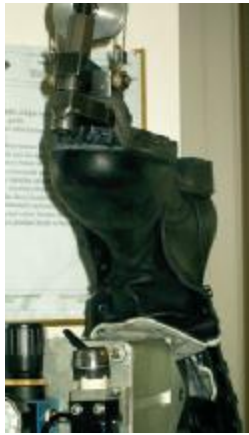
Fotoğraf 8.3: Ayakkabının tabanının sayadan ayrılmaya başlaması
