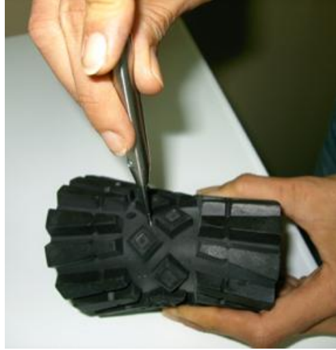
Fotoğraf 4.2: Test parçasına kesik açılması
