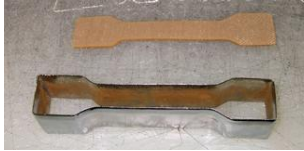
Fotoğraf 2. 2: Test parçası ve kesim bıçağı
