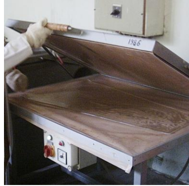
Resim 1.6: Pres Fırında malzemenin hazırlanması
