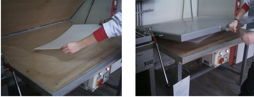
Resim 1.5: Pres Fırına malzeme bırakma
