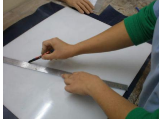
Resim 1.4: Malzeme üzerine kesim çizgisinin çizilmesi
