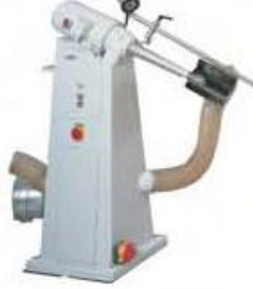
Resim 2.9: Hunili freze makinesi
