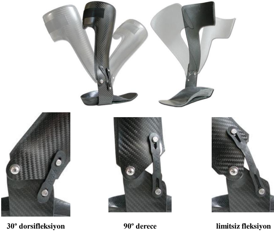
Resim 2.35: Dorsifleksiyon destekli karbon AFO
