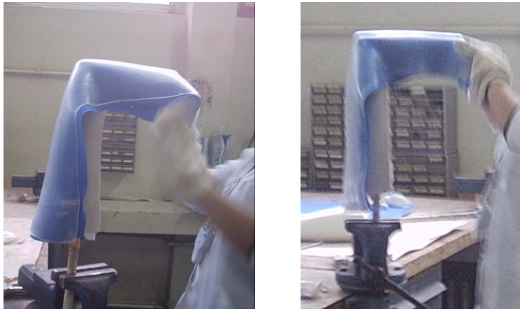
Resim 1.9: Plastizotu palastik ile derin çekme
