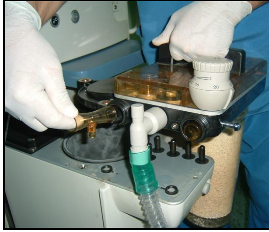
Şekil 8.2: Akış sensörü montajı
