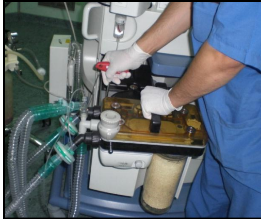
Şekil.6.1: Solunum sisteminin montajı
