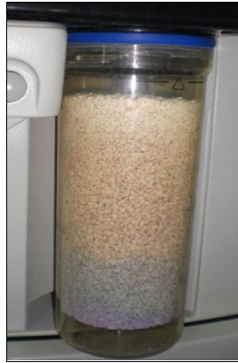
Resim 5.1: Kullanılan absorbanda renk deđiřikliđi
