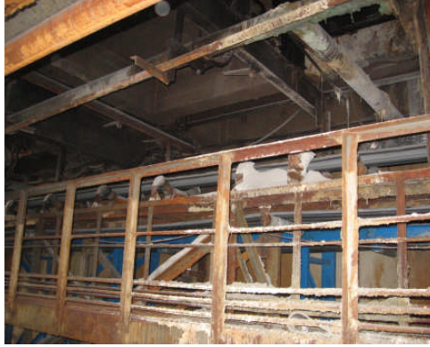
Resim 2.5: Amonyum sülfat tuzlarının bantlarla taşınması
