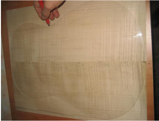
Resim 1.8: Arka kapak üzerine formun çizilmesi
