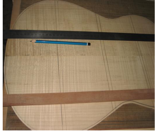
Resim 1.12:Üç adet balkon yerlerinin tespit edilmesi
