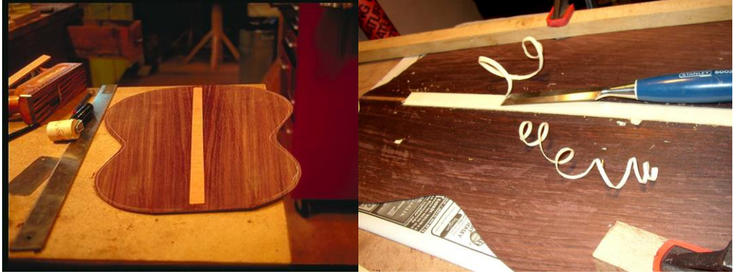
Resim 1.11: Birleşme noktasına mukavemet papelinin yapıştırılması ve temizliği
