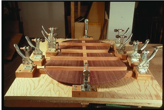
Resim 1.13: Balkonların hazırlanıp yapıştırılması
