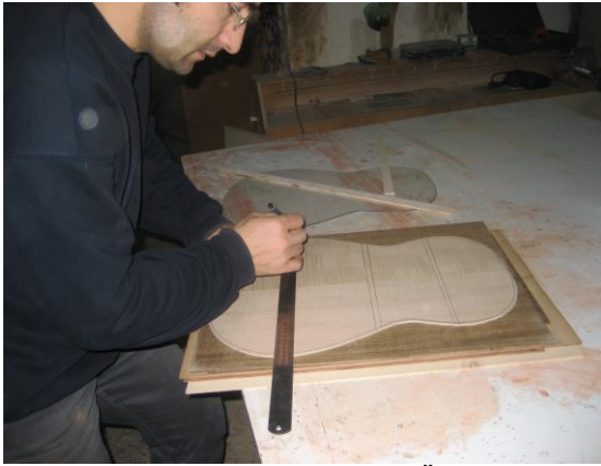
Resim 1.12:Üç adet balkon yerlerinin tespit edilmesi
