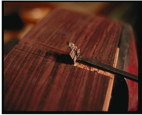
Resim 2.6:Yanlıkların birleşme yerinde filato çizimi
