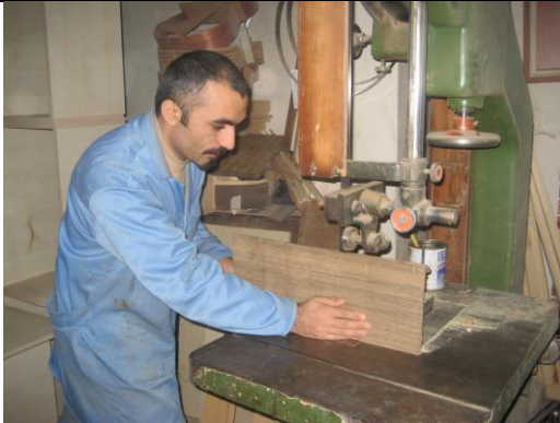
Resim 1.3:Arka tablonun kesilmesi
