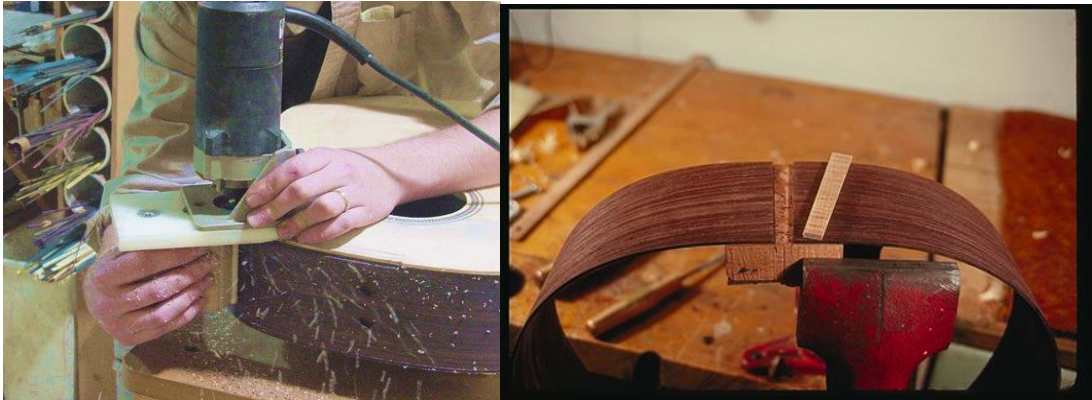
Resim 2.8:Filato kanallarının iskarpile veya el frezesiyle boşaltılması
