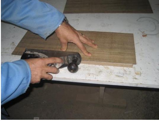
Resim 1.4:Parçaların el planyası ile alıştırılması
