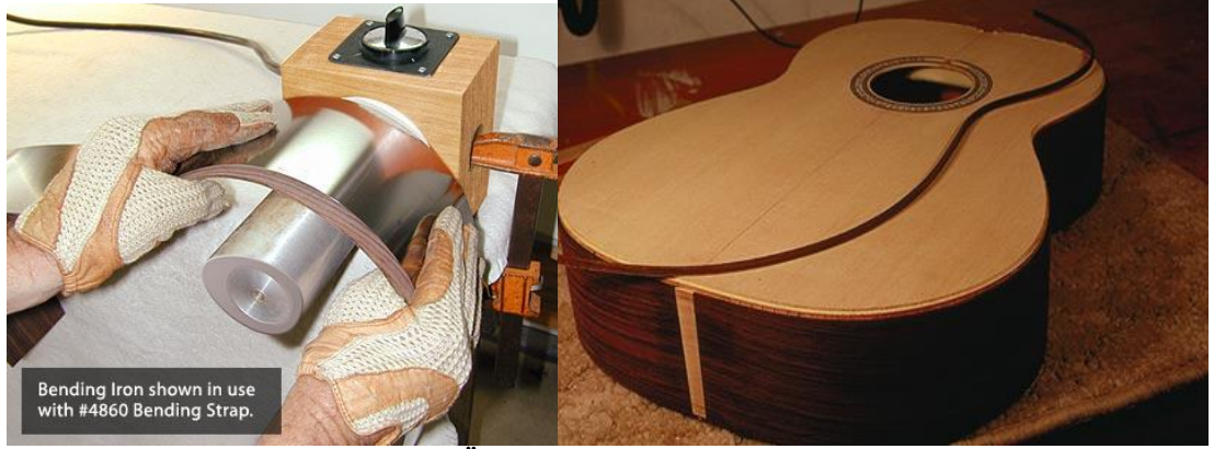
Resim 2.4:Ütüyle bükme işleminin yapılması
