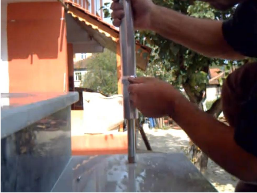
Fotoğraf 2.6: Dikme çubuğunun ankaryaj demirine montajı
