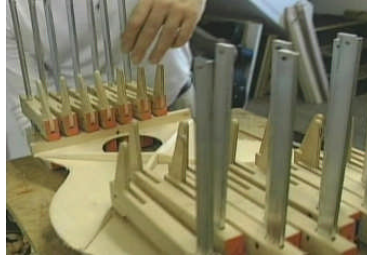
Resim 2.11: B3 balkonunun yapıştırılması
