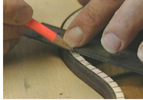
Resim 3.5: Kenar mukavemet ıtalarına balkon ularının markalanması
