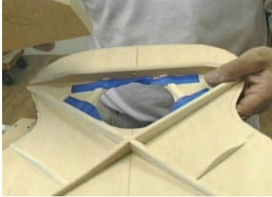
Resim 2.15: B5 balkonların takoz yardımıyla sıkılması
