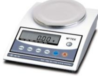
Resim 2.3: Hassas terazi (Düşük gramajlarda kullanılır)
