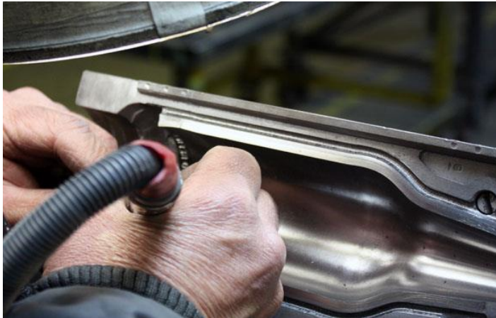
Resim 1.1: Şişirme kalıbında bakım çalışması
