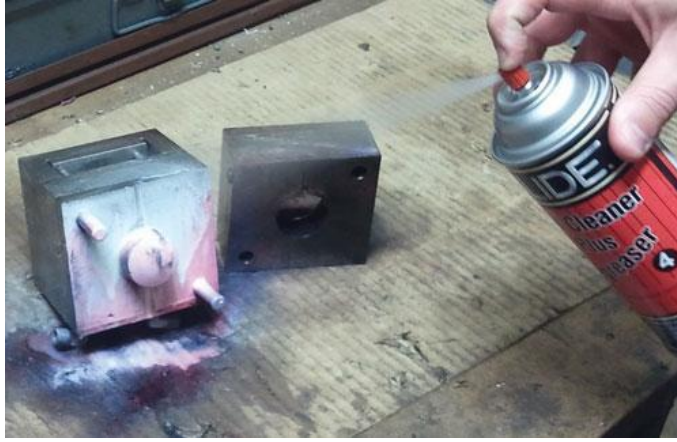
Resim 2.2: Kalıpların spreyle temizliği
