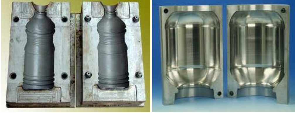
Resim 1.6: Plastik ekstrüzyon ve enjeksiyon şişirme kalıbı
