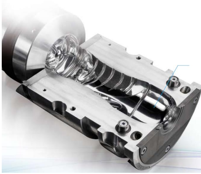
Resim 2.5: Bakım sonrası enjeksiyon şişirme kalıbı
