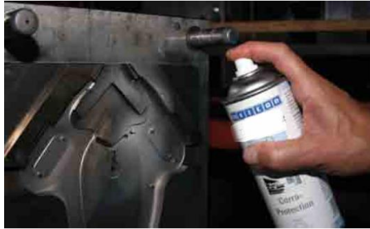
Resim 2.6: Yüzey ve korozyon korumasında kullanılan metal spreyleyler
