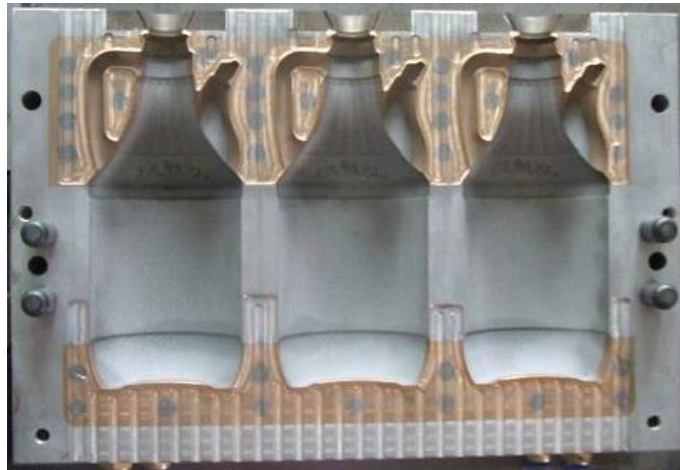
Resim 1.4: Ekstrüzyon şişirme kalıbı
