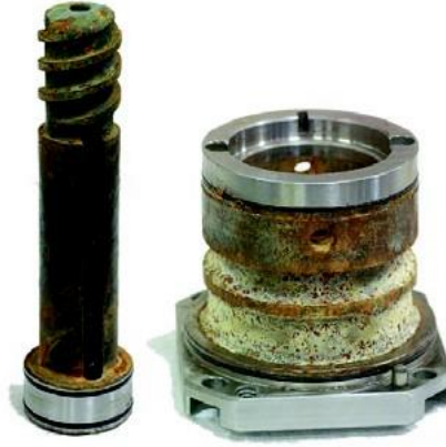
Resim 1.3: Paslanmış ve kireçlenmiş soğutma ünitesi elemanları
