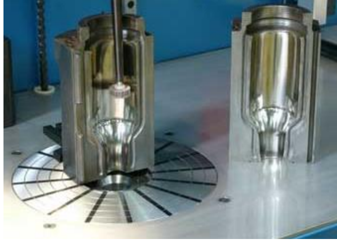
Resim 2.3: Şişirme kalıbında parlatma
