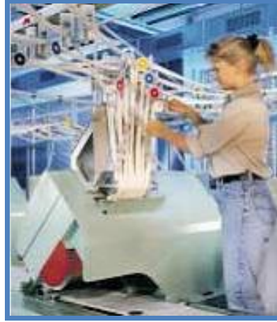
Resim1.8: Çađlıktaki uçuntuların temizlenmesi
