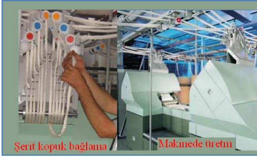
Resim 2.6: Makinede kopuk şerit bağlama ve üretim
