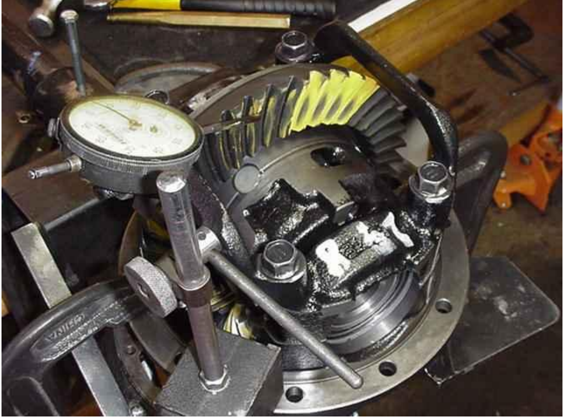
Resim 2.7: Ayna dişli ile mahrutu dişli arasındaki boşluğun mıknatıslı komparatörle kontrolü
