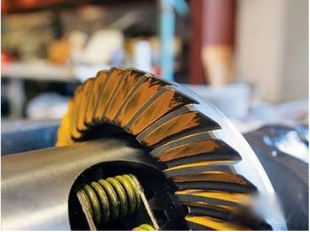
Resim 2.8: Sülyen boya ile ayna ve mahruhi dişlileri arasındaki iz kontrolü
