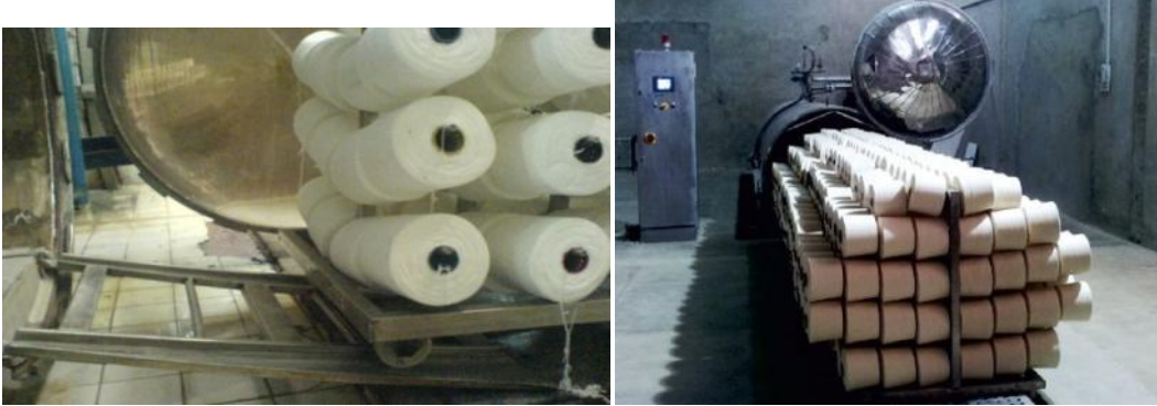
Resim 1.23: Arabaların ray üzerinden makineye beslenmesi
