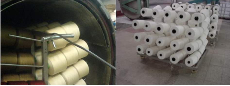
Resim 1.29: Fikse olmuş iplik yüklü arabaların çengel çubuk yardımıyla çıkarılması
