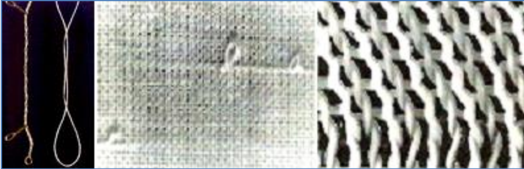
Resim 1.3: Kendi üzerine bükümlenmiş iplik ve ondan oluşan dokuma, örme hataları
