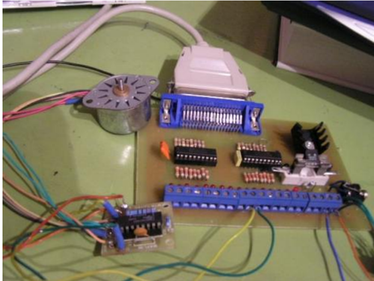
Şekil 2.2: Paralel port ile kontrol için elektronik devre
