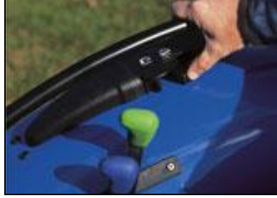
Resim 2.14: Traktör lift-o-matik kumanda düğmesi
