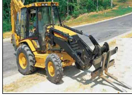
Resim 1.17: Makinenin forklift gibi kullanılması
