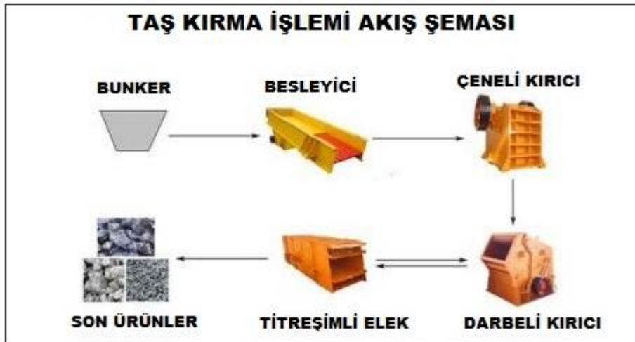
Şekil 3.2: Taş kırma işlemi akış şeması
