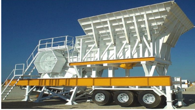
Resim 3.14: Mobil taş kırma ve eleme tesisi
