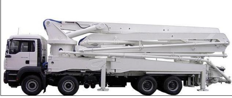
Resim 1.34: Mobil beton pompası
