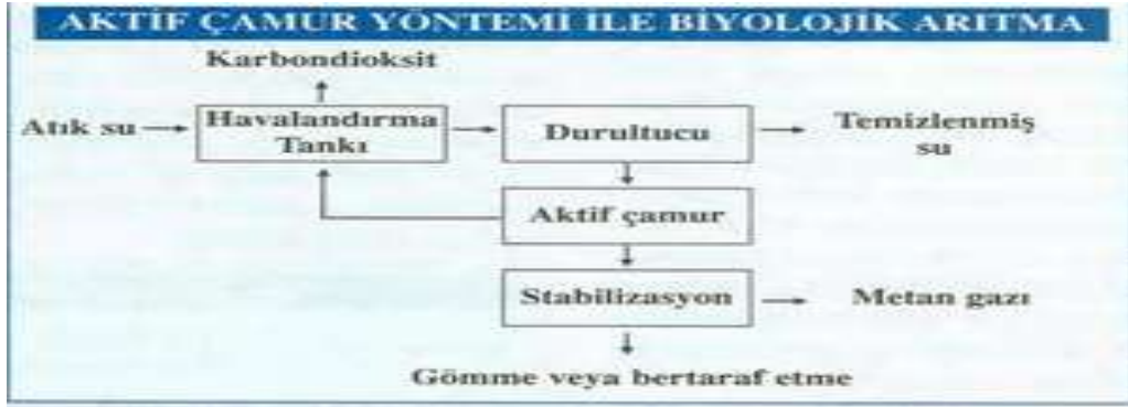
Şekil 2.2: Aktif çamur yöntemi ile biyolojik arıtma
