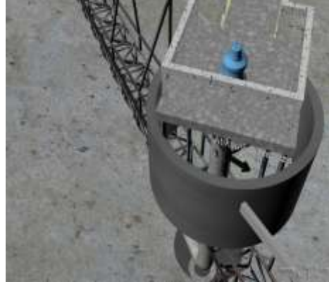
Resim2.7: Atık suyun havuza girişi
