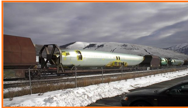
Resim 1.2:Yükün özelliği ve ağırlığı veya boyutları nedeniyle kullanılan özel vagon
