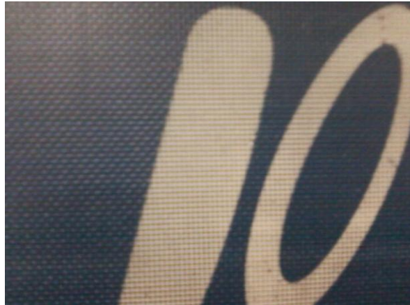
Resim 3.3: Sim baskıda kullanılan baskı şablonunun yakından görünüşü
