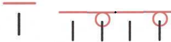
Şekil 2.14: Atlama ilmek teknik çizimi
