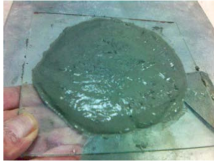
Resim 1.27: Numuneyi sarsarak yayılmasını sağlama
