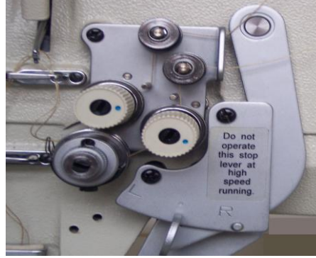
Şekil 2.5: Çift iğne dikiş makinesinde sağ ve sol iğne iptal kolu
