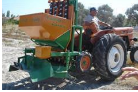
Resim 1.17: Nergis soğanı dikim makinesi
