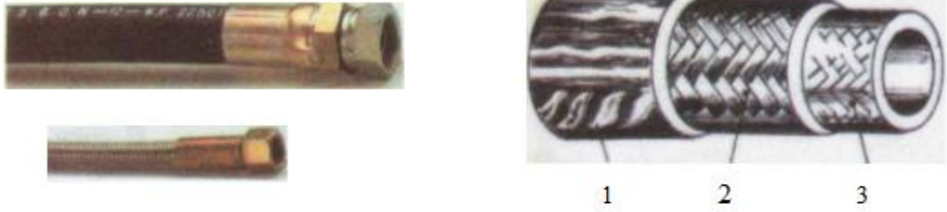
Şekil 3.4: Esnek hortum 1. Üst tabaka (poliüretan) 2. Basınç taşıyan çelik örgü 3. Hortum iç tabakası (elastomerden)
