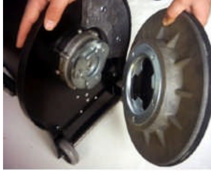
Resim 1.3: Cila Makinası disk sürücüsünün takılması
