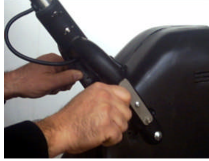
Resim 1.14: Makineyi taşımak için kol dik duruma getirilir. Makine bastırılarak tekerleklerin yere basması sağlanır. Çekerek hareket ettirilir.
