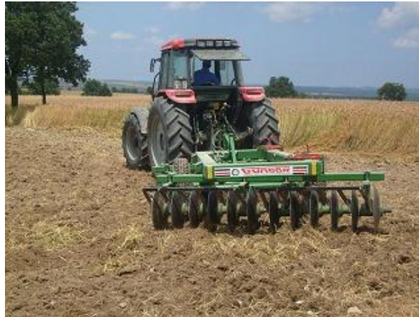
Resim 2.10: Diskaro ile toprak işleme
