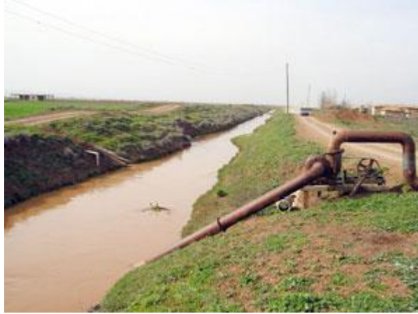
Resim 1.4: Sulama için su kaynağından suyun motorla alınması
