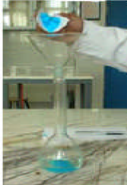
Resim 1.5: Çözünen maddenin balon jøjeye aktarılması
