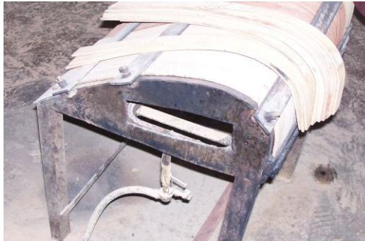
Resim 2.2: Çöğür dilimleri eğme(ısıtma) kalıbı
