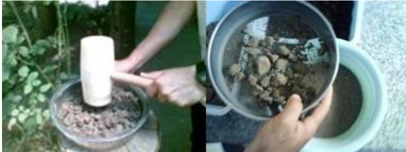
Resim 2.3: Numunelerin havanda dövülerek öğütülmesi ve elenmesi
