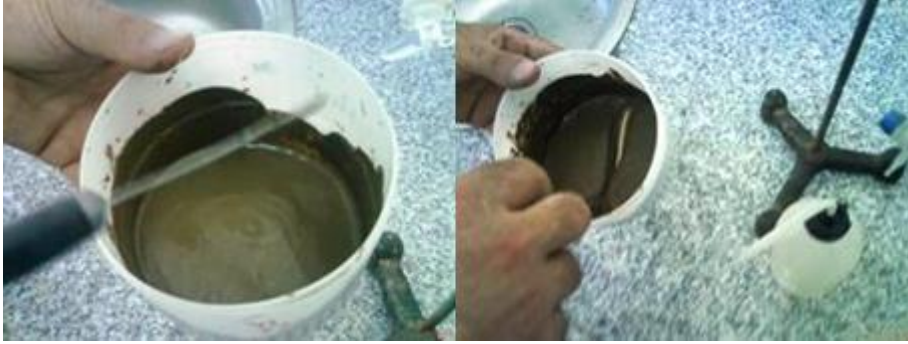
Resim 3.2: İdeal doygunluk şartları sağlanmış saturasyon macunu
