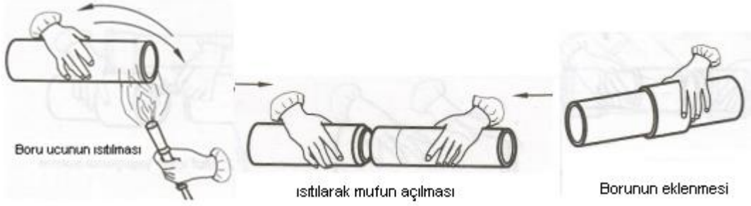
Şekil 2.2: PVC borunun yapıştırma ek işlemleri
