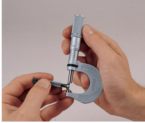
Fotoğraf 2.13: Mikrometre ile ölçme
