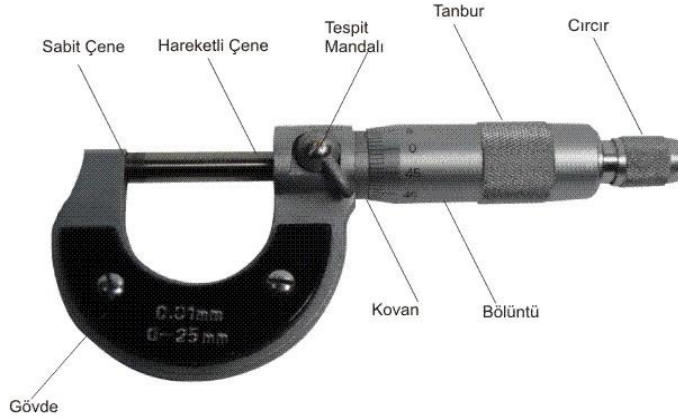
Fotoğraf 2.14: Mikrometrenin iç yapısı ve kısımları
