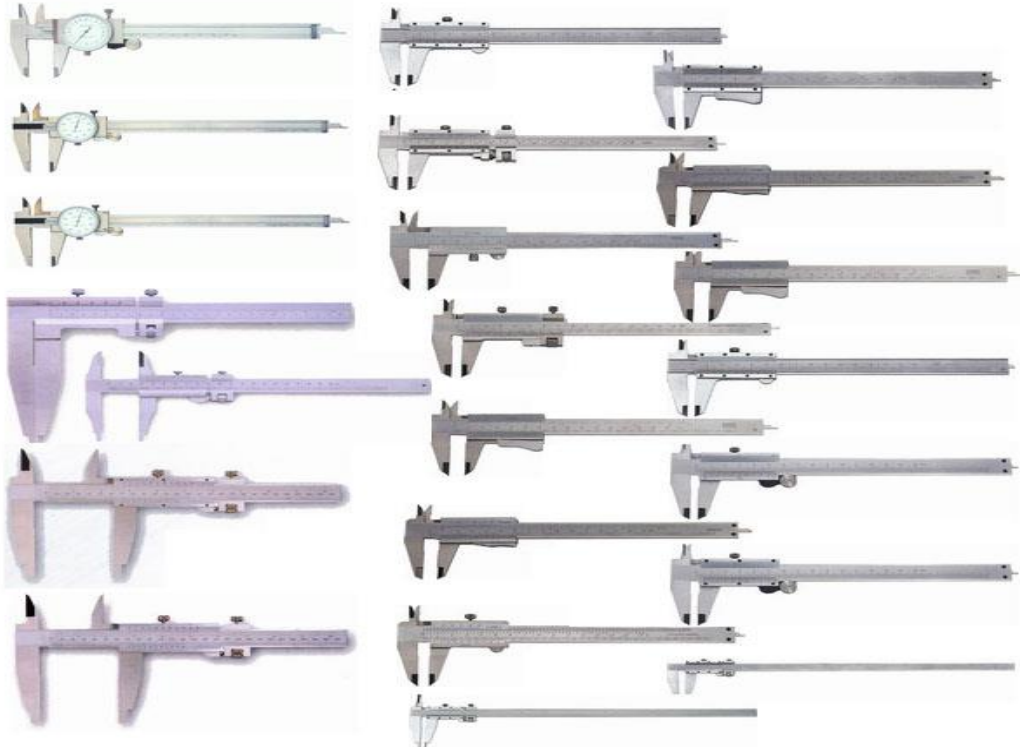
Fotoğraf 2.9: Değişik amaçlar için üretilmiş sürmeli kumpaslar
