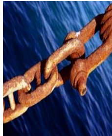
Fotoğraf 1.14: Korozyona uğramış zincir
