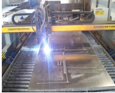
Fotoğraf 1.4: CNC ile gemi yapı elemanları kesimi
