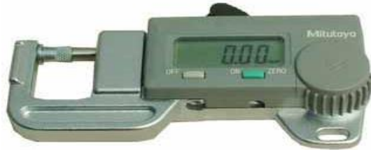
Fotoğraf 2.5: Dijital (elektronik) mikrometre
