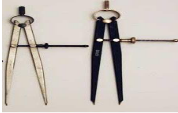
Fotoğraf 3.7: Pergel uçlarının paralellikleri
