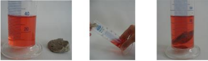
Resim 2.4: Boyutları ölçülemeyen katı maddelerde hacim ölçümü
