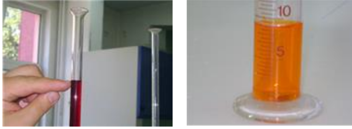
Resim 2.5: Renkli sıvılarda menisküs ve hacim okuma
