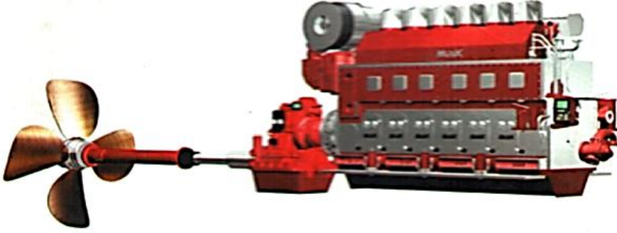
Resim 1.1: Dizel motor devir düşürücü ile pervane bağlantısı
