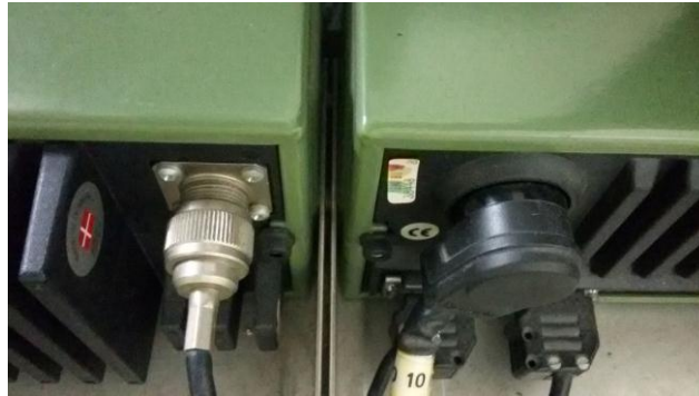
Resim 1.11: VHF koaksiyel anten kablosu BNC soketi
