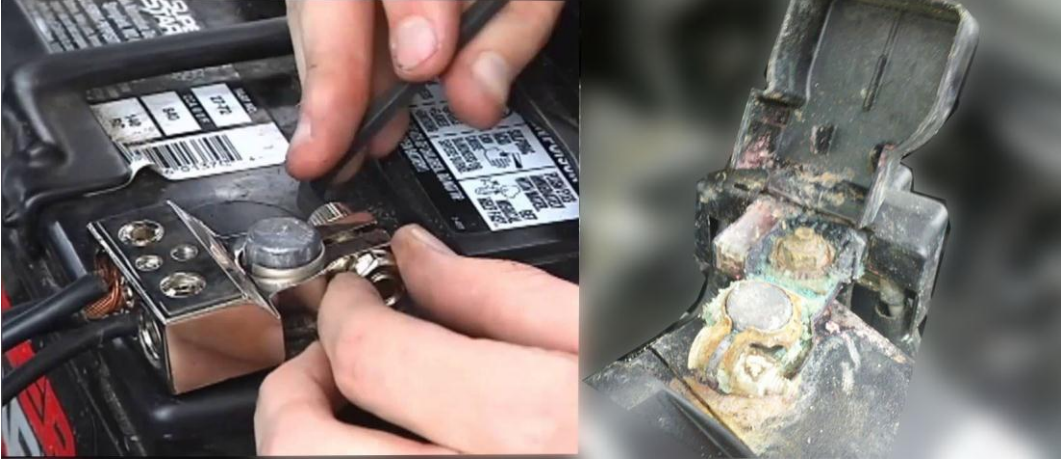
Resim 2.3: Kablo pabucunun montajı ve oksitlenmiş bir kutup başı
