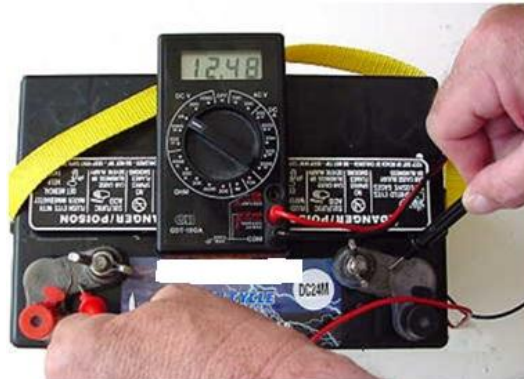
Resim 1.9: Kapalı tip bataryanın ölçülmesi
