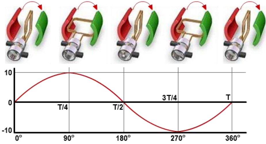
Şekil 1. 3.: Alternatör içerisinde 90 derecelik dilimlerle işaretin elde edilmesi
