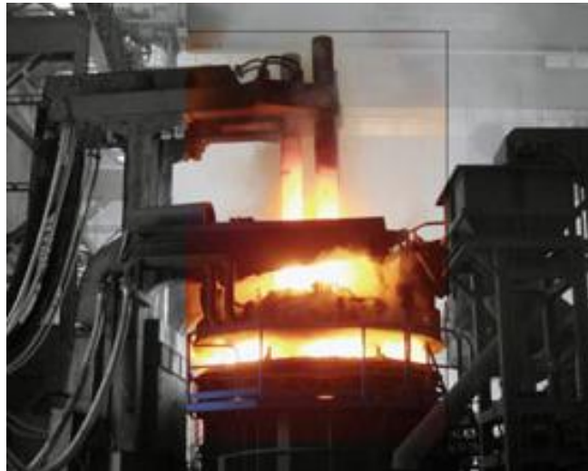
Resim 1.3: Bir ark fırınında ergitme işlemi
